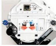
L'angle peut être réglé en tournant les boutons latéraux dans une plage de  $\pm 3^\circ$ .
