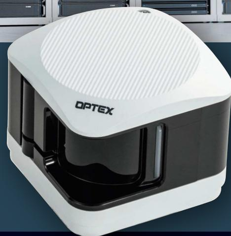
REDSKAN Lite est un détecteur d'intrusion de haute précision qui crée un mur laser virtuel invisible pour une couverture totale allant jusqu'à 10 m x 10 m. Grâce au balayage LASER, il détecte instantanément et de manière fiable, quelles que soient les conditions d'éclairage ou de température.
