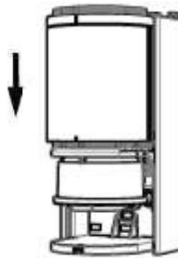
[6] Reliez l'unité pour ajuster son angle afin de répondre aux conditions d'installation du détecteur (angle réglable : 96 ° à gauche et à droite).
