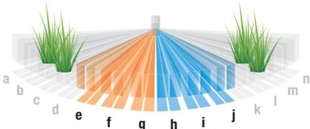
Quando posizione di mascheramento dell'otturatore è che a sinistra è d e destra è k, area di rilevazione a-d e k-n sono mascherati.
