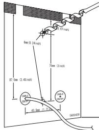
La distance entre le sol et la base du gabarit doit être comprise entre 2,3 m (7,6 ft.) et 4 m (13 ft.).
