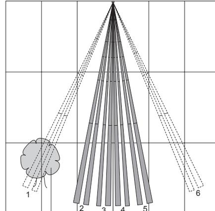
Si des branches d'arbres ou d'autres objets mobiles se trouvent dans le faisceau de détection.
