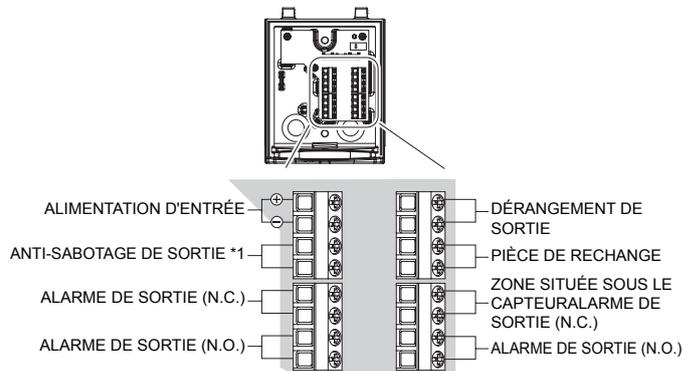
\*1 : bornes anti-sabotage à connecter à une boucle de supervision 24/24.
