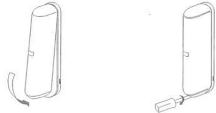
Après avoir vérifié l'alignement optique et tester le fonctionnement (Voir § 8), remplacer le capot et le fixer avec la vis de fermeture.
